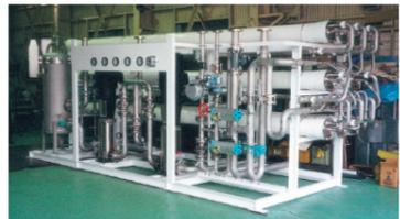
イオセップは様々な原水水質や要求水質にも応えられるよう、超低圧から低圧膜、そして汚れに強い膜と各種の膜を揃え、最適設計を目指してシステム化した逆浸透膜装置です。
