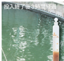
スラッジゾーンが低下し、汚泥の流出も止まった。
