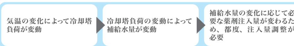
マイガードICB-Eシリーズのシーズンタイマーは、1月から12月それぞれの月の冷却塔負荷をパーセント(%)であらかじめ設定するだけで薬注量を負荷に応じた値に自動的に調整します。この結果、いつも適正な量の冷却水処理剤を注入することができます。
