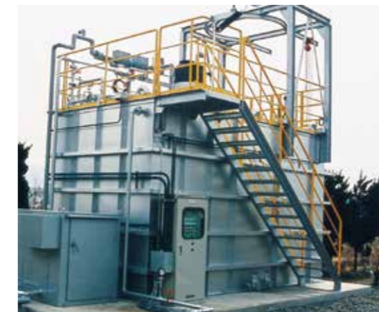
膜分離式活性汚泥処理設備 アクアス®ビオマスク 活性汚泥処理設備における固液分離(放流水と汚泥の分離)は、従来、沈殿槽を用いて行われてきましたが、沈殿槽の代わりに分離膜で分離するシステムです。
