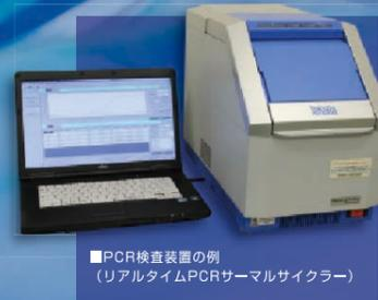
■PCR検査装置の例
